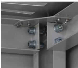
Сборно-разборная конструкция шкафов LINEA В обеспечивает простоту и удобство при сборке и транспортировке.
