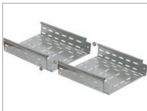
Лотки имеют разъемы «мама-папа», с помощью которых они соединяются и прочно фиксируются комплектом соединительным КС М6 ´ 10. Стандартная длина лотков – 3 метра.
