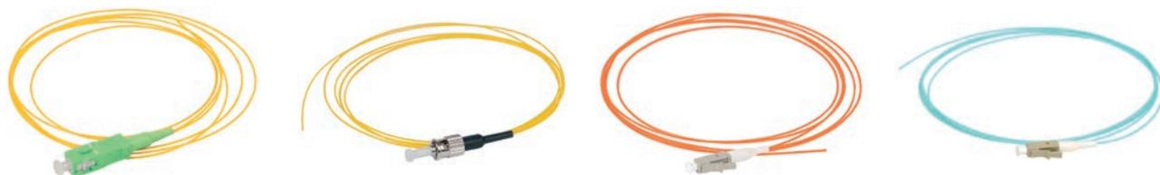
Оптические монтажные шнуры или по-другому пигтейлы (в простонародье – порсячий хвостик) представляет собой отрезок кабеля, оконцованный с одной стороны разъемом, второй конец соединяется с волокном с помощью сварки. Длина наших пигтейлов составляет 1,5м. Существуют также одномодовые и многомодовые пигтейлы, одномодовые имеют внешнюю оболочку желтого цвета, многомодовые – оранжевого.
