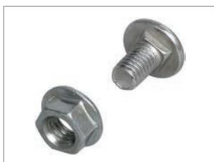
Все лотки и аксессуары соединяются между собой при помощи унифицированного комплекта соединительного КС М6 ´ 10. Таким образом, для сборки трассы любой степени сложности необходимо всего три вида метизов. Благодаря квадратному подголовнику, фиксирующему болт из комплекта соединительного КС М6 ´ 10, для соединения лотков и аксессуаров нужен только один ключ М10.
