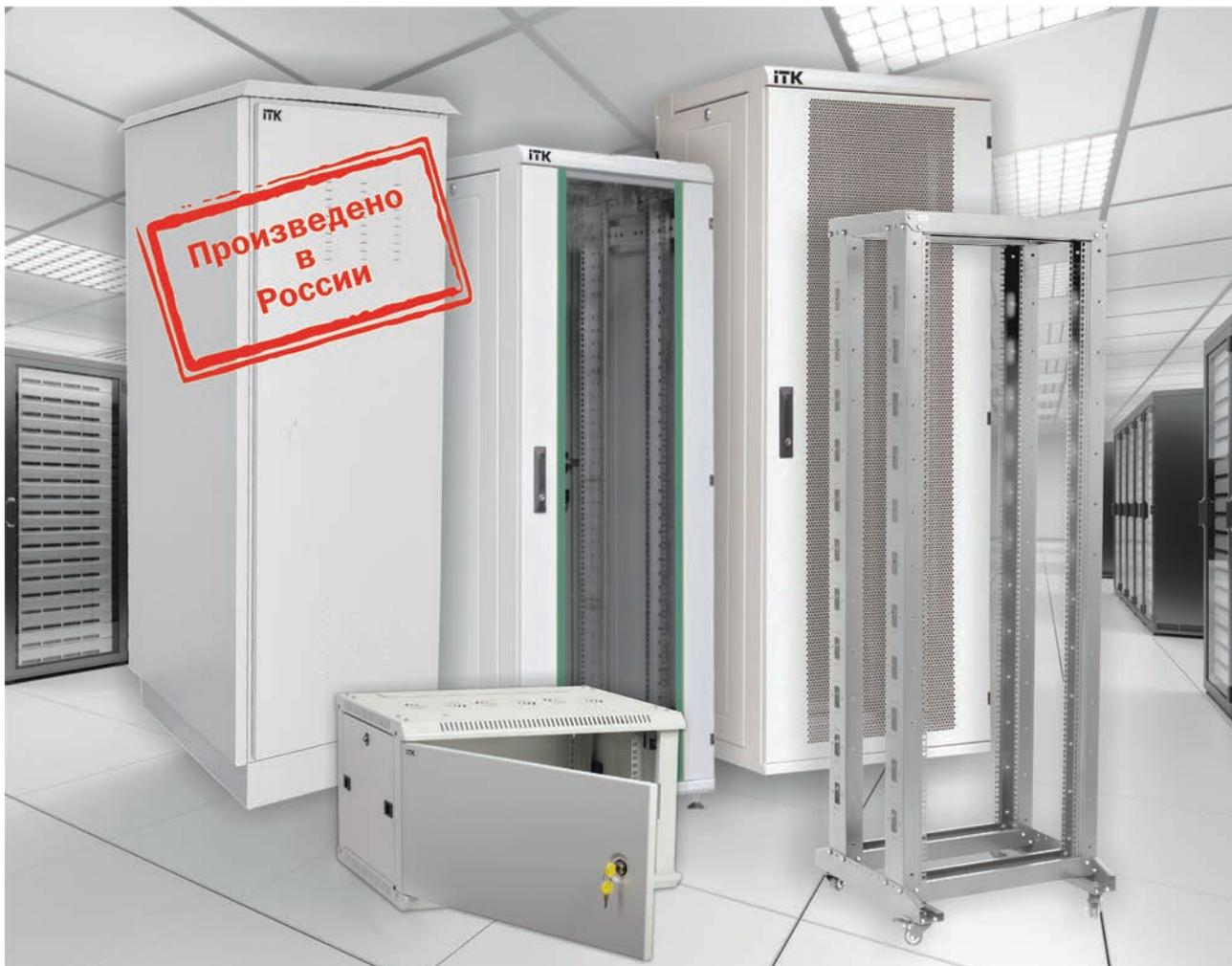
19-дюймовый (19") монтажный шкаф ИТК® представляет собой конструктив, выполненный из рамы каркаса, нижней и верхней панелей, боковых и задней стенок, передней двери и монтажных направляющих, к которым и крепится монтируемое оборудование. Расстояние между направляющими составляет 482,6 мм или 19". Высота 19" шкафов и стоек также стандартизована и измеряется шагом в один юнит (1U). 1U равен 1,75" или 44,45 мм.
