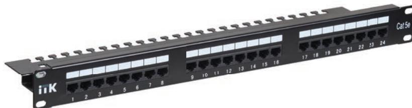
Все патч-панели ИТК® категории 5E STP соответствуют международным стандартам UL 1863, ISO/IEC 11801:2002, TIA/EIA-568-B, кодировка проводников сзади в соответствии с T568B и A, поставляются в картонной коробке с крепежом.
