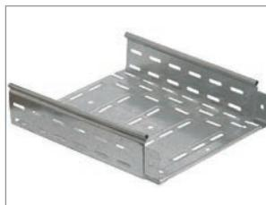
Развитая перфорация значительно снижает вес лотка, не изменяя его прочностные характеристики, и позволяет легко закреплять внутри лотка кабель при помощи нейлоновых стяжек.
